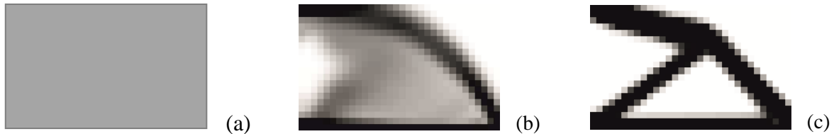
Figura 1. Processo de otimização de topologia: (a) Distribuição inicial de material uniforme em todo o domínio estendido; (b) Fase intermediária do processo; (c) Solução final.
