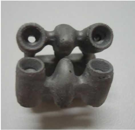
Figura 5. Padrões metálicos obtidos após desinclusão.
