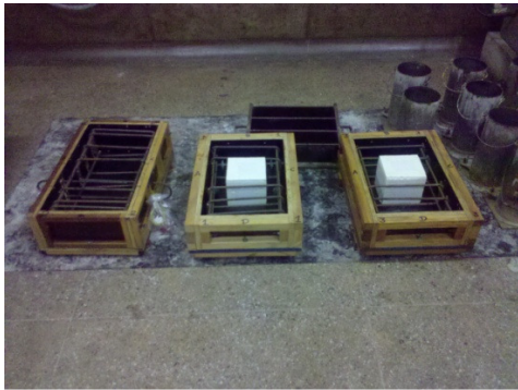
a) Fôrmas para concretagem da primeira etapa – peças
