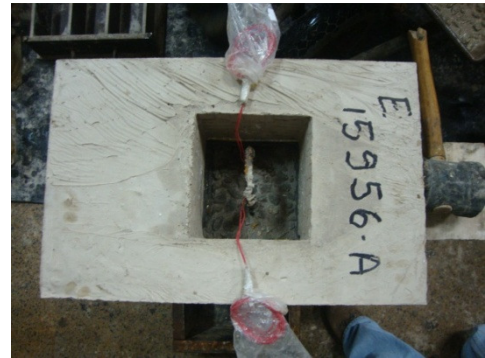
d) Posicionamento da peça lateral sobre a peça central
