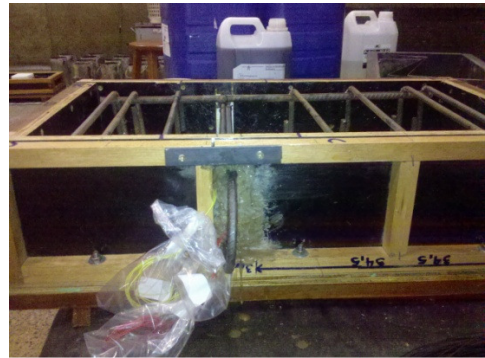
b) Detalhe do conector na fôrma da peça central
