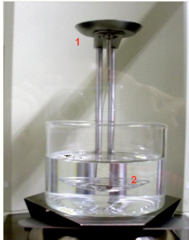
Figura 4. Aparato utilizado para medir a densidade relativa.
