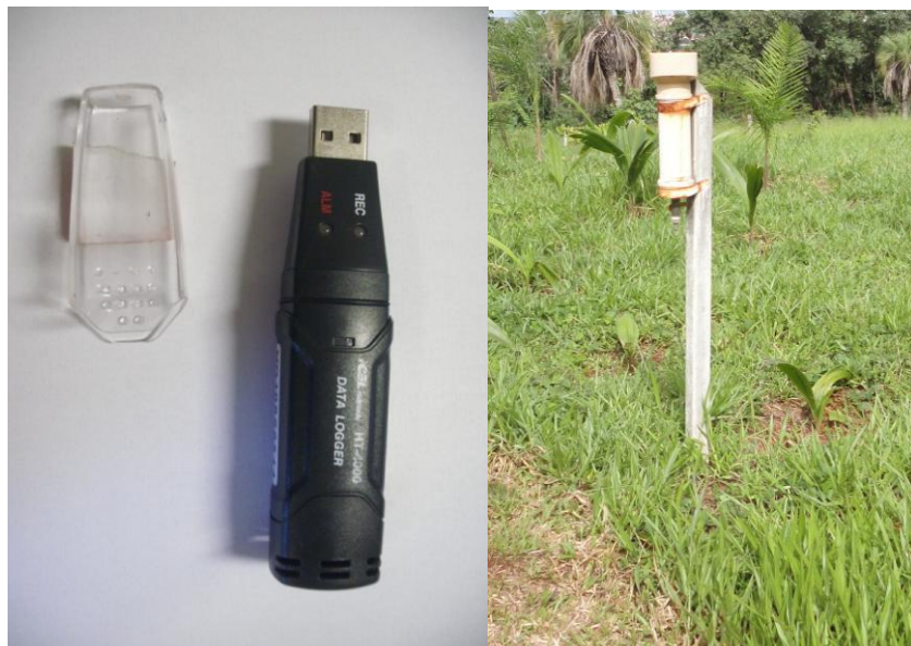
Figura 2 - Termohigrômetro e pluviômetro. Foto: José Ricardo Rodrigues Rocha, (2011)
