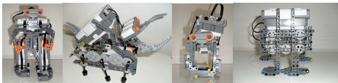
Figura 1 – Exemplos de protótipos que caminham através de pernas.
