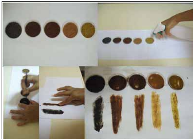
Figura 3: Modelo de experiência para ensinar as diferentes as cores dos solos.
