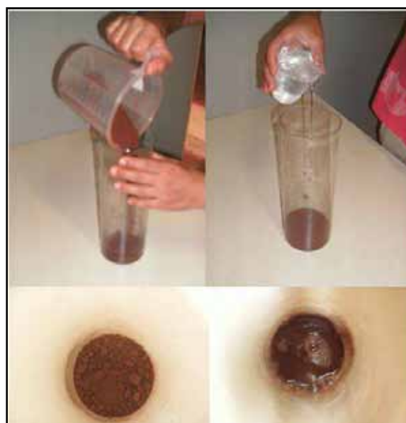
Figura 4: Experiência para demonstrar existência de ar no interior do solo.
