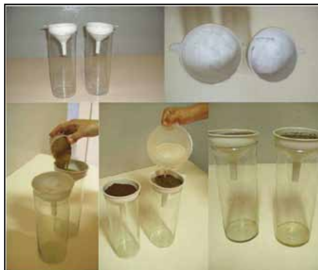
Figura 1: Representação da execução da experiência proposta no manual de solo para demonstrar diferenças na infiltração de água entre solo arenoso e argiloso.
