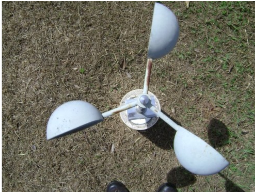
Figura 5: Anemômetro totalizar de conchas
