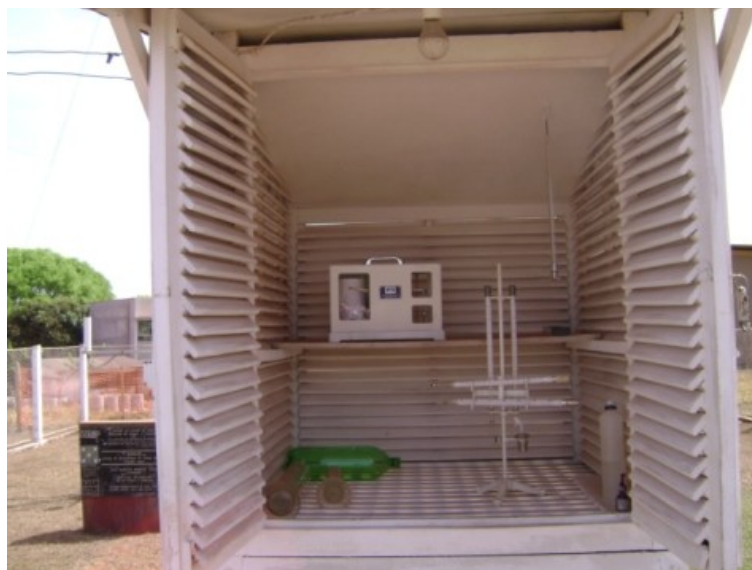
Figura 3: Aparelhos dentro do abrigo meteorológico.
