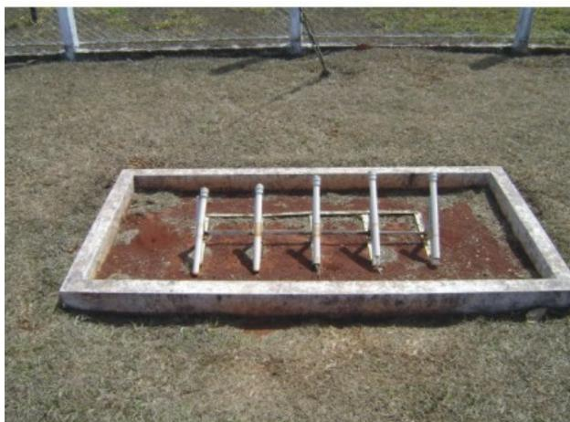
**Figura 6- Geotermômetro**
