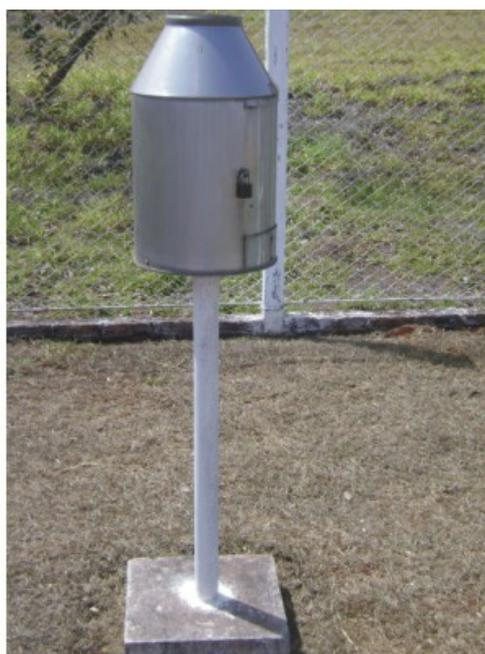
**Figura 9- Pluviógrafo**
