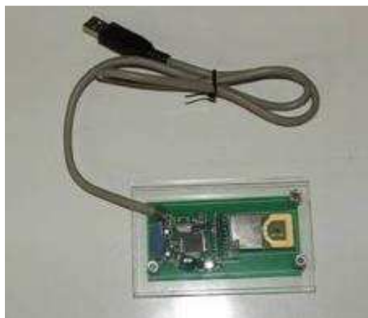
Figura 4 – Foto do PCLink (Transceptor de Rádio Freqüência)
