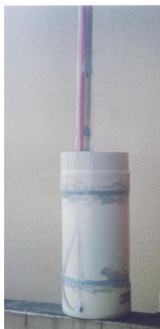
Figura 2. Redutor de diâmetro de 200mm para 40 mm, com tubo de 40 cm de altura e fita graduada.
