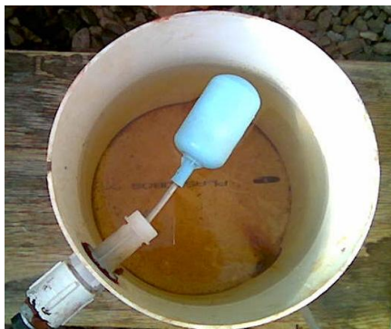
Figura 3. Bóia para filtro mantendo o nível de água a 15 cm no reservatório (R2) e no vaso (V).
