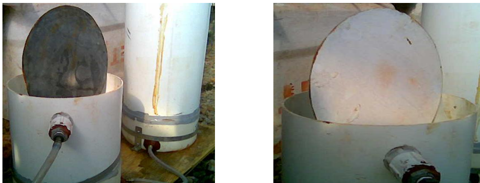
Figuras 4. (a) Detalhamento da tampa do reservatório (R2) confeccionada de chapa de metálica, com a parte interna revestida de câmara de pneu e (b) a parte externa com pintura esmalte branca.
