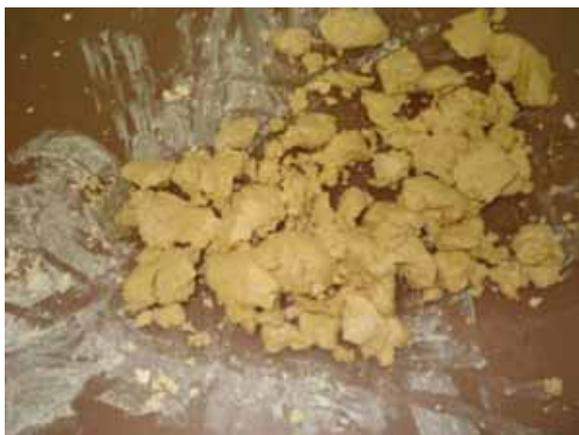
Figura 4 – Aspecto do fosfogesso durante a realização dos ensaios de limite de Atterberg
