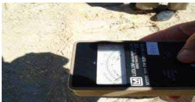
Figura 3- Medição da taxa de exposição com contador Geiger no momento da coleta
