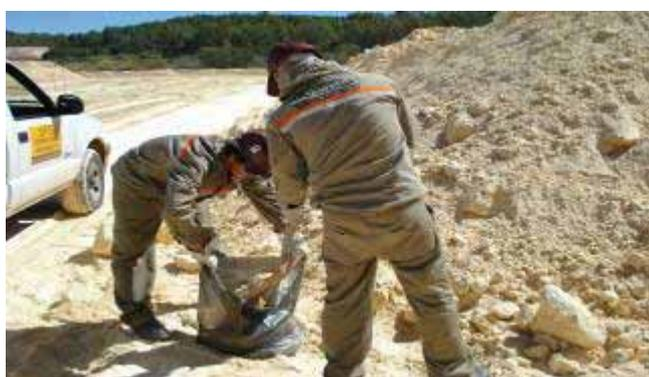
Figura 2- Coleta de amostras do fosfogesso
