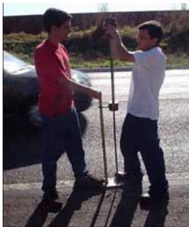
Figura 2.1 Realização do Ensaio com DCP
