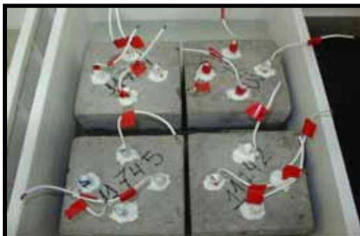
**Figura 2- Imersão em solução agressiva contendo cloretos na concentração de 5% em massa.**
